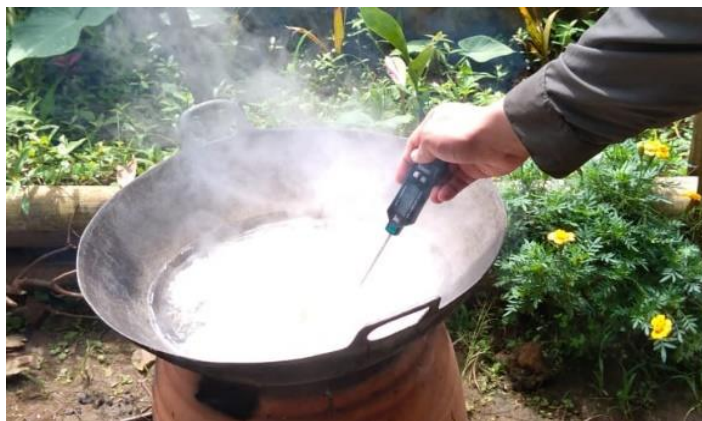
Gambar 4. Proses pengukuran suhu gula aren yang sedang dimasak
