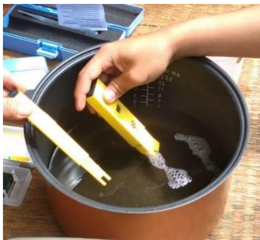
Gambar 3. Proses analisis kualitas Nira menggunakan pH meter
